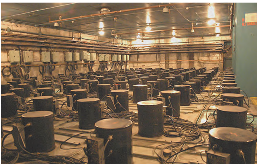
Баксанская нейтринная обсерватория. Зал с контейнерами с галлием
